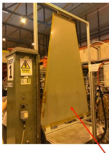
Fig. 6.9: Prototipo GE2/1 con settori M4 a \mu -RWELL. La freccia indica il settore del modulo M4 sul quale è stata eseguita la misura di efficienza.
