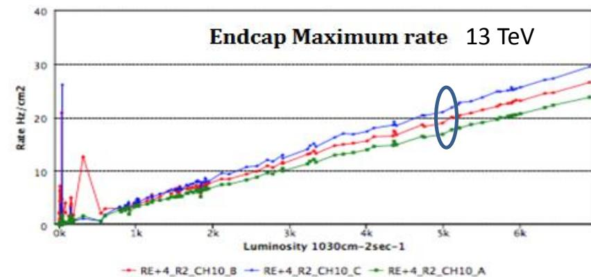
Dai dati sperimentali ottenuti dai run 1 e run 2 è possibile estrapolare il massimo valore di rate atteso nell'Endcap in funzione della luminosità. Al valore trovato va aggiunto un fattore correttivo di 1.5 per tener conto dell'aumento di energia, ed un fattore di sicurezza pari a 3.
