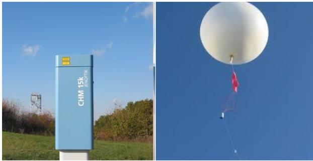
Fig. 11: (sinistra) Lidar installato in prossimità di Taranto; (destra) Pallone Sonda utilizzato a Brindisi per il Radio Sondaggio.
