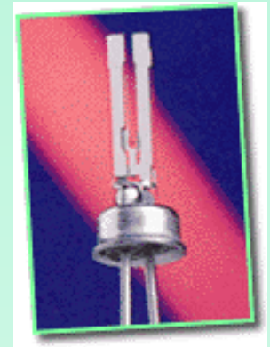
Miniature quartz tuning fork; 32,768 Hz.
