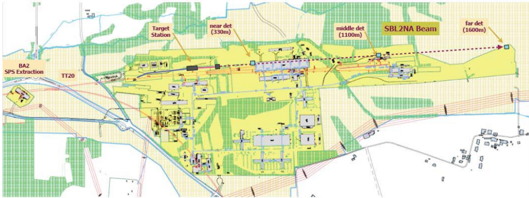
Figura 2.4: Layout del fascio di neutrini presso la North Area del CERN. La figura mostra il luogo di estrazione del fascio primario, la posizione del bersaglio, la posizione dei due rivelatori Near e Far, un sito per un eventuale Middle detector posizionato tra il Near e il Far. [82]
