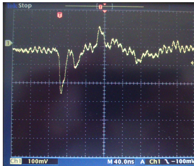
Figura 4.16: Segnale di un rivelatore RPC visto all'oscilloscopio.
