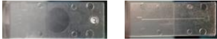
Fig. 5: A) Piastrina superiore con fori per la connettorizzazione; B) piastrina inferiore con canale e alloggiamento fibre.
